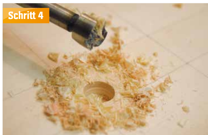
Das Element für die Tretwippe mit einem Bohrer vorbohren, damit man innen mit dem Sägeblatt ansetzen kann.
