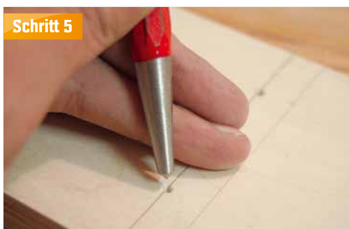
Die Bohrungen an der Tretwippe genau ankönnen und bohren.
