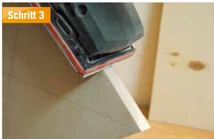
... und feinschleifen. Mit einem Schleifblock bleiben die Kanten beim Schleifen plan.
