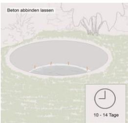
Lassen Sie den Beton 14 Tage lang abbinden. Wenn Sie einen Filterschacht bauen, führen Sie diesen Schritt auch in der für den Filterschacht vorgesehenen Fläche durch.
