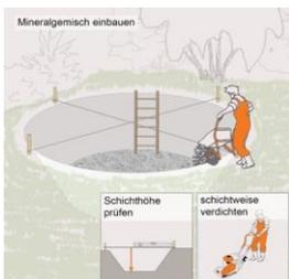
Verteilen Sie ca. 15 cm Mineralgemisch in mehreren, jeweils ca. 5 - 10 cm starken Schichten in der Grube. Verdichten Sie jede Schicht einzeln, indem Sie mehrfach mit der Rüttelplatte über den Bereich fahren. Achten Sie darauf, dass die Fläche nach vollständigem Einbau und Verdichten möglichst gerade und eben ist. Wenn Sie einen Filterschacht bauen, führen Sie diesen Schritt auch in der für den Filterschacht vorgesehenen Fläche durch.
