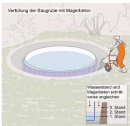
Hinterfüllen Sie jetzt den Pool, indem Sie mit einer Schaufel den Raum zwischen Erdreich und Pooldämmung mit dem Magerbeton auffüllen. Dies sollte in mehreren Schichten von ca. 30 cm und rund um den Pool erfolgen. Warten Sie mit dem weiteren Auffüllen bis die vorherige Schicht abgebunden ist. Der Wasserstand sollte mit jeder Schicht erhöht werden, um eventuelles Eindrücken zu verhindern.
