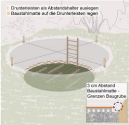
Legen Sie die Drunterleisten als Abstandshalter auf die Bauplane. Anschließend können Sie die Baustahlmatte auf den Drunterleisten ausbreiten. Benötigen Sie mehrere Baustahlmatten, dann verlegen Sie diese mit drei Feldern Überlappung. Achten Sie darauf, dass mindestens 3 cm Abstand zwischen Baustahlmatte und Außenwand bestehen. Wenn Sie einen Filterschacht bauen, führen Sie diesen Schritt auch in der für den Filterschacht vorgesehenen Fläche durch.
