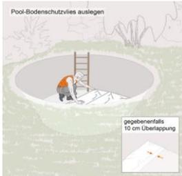
Reinigen Sie zunächst die Fläche gründlich. Vergewissern Sie sich dabei, dass die Fläche vollständig gesäubert ist, da sich selbst kleinere Rückstände später durch den Wasserdruck unter der Poolfolie abzeichnen könnten. Legen Sie anschließend das Pool-Bodenschutzvlies aus. Sollte das Vlies aus mehreren Stücken bestehen, verlegen Sie es mit mindestens 10 cm Überlappung.
