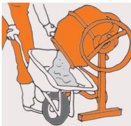
Zum Anmischen des Materials wird sauberes und kaltes Wasser in ein Gefäß gegeben und das Material langsam eingestreut. Magerbeton wird in einem Verhältnis 8:1 angemischt, 8 Teile Kies (0-16) zu 1 Teil Zement. Der Magerbeton soll erdfeucht bis leicht plastisch werden, damit er gut verarbeitet werden kann. Anschließend wird das Material durchgemischt. Hierfür empfiehlt sich ein Betonmischer. Nach der Reifezeit (siehe technische Daten) muss der Magerbeton noch einmal gründlich durchgemischt werden.
