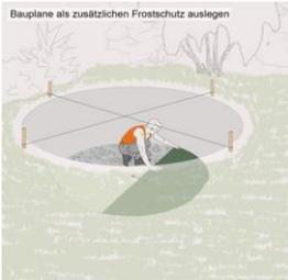
Legen Sie eine Bauplane aus. Sie dient als Frostschutz und verhindert das Aufsteigen von Feuchtigkeit. Wenn Sie einen Filterschacht bauen, führen Sie diesen Schritt auch in der für den Filterschacht vorgesehenen Fläche durch.
